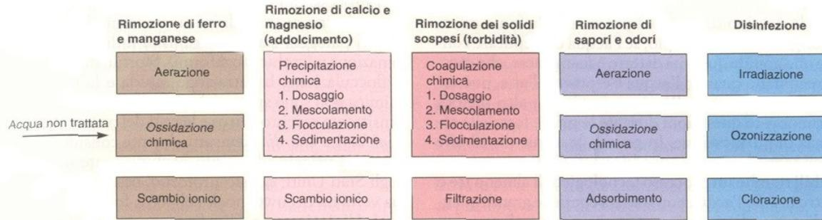
**Potabilizzazione dell'acqua.** Sono disponibili numerose alternative per il trattamento di correzione e/o purificazione e la scelta deve tenere conto della qualità dell'acqua di
