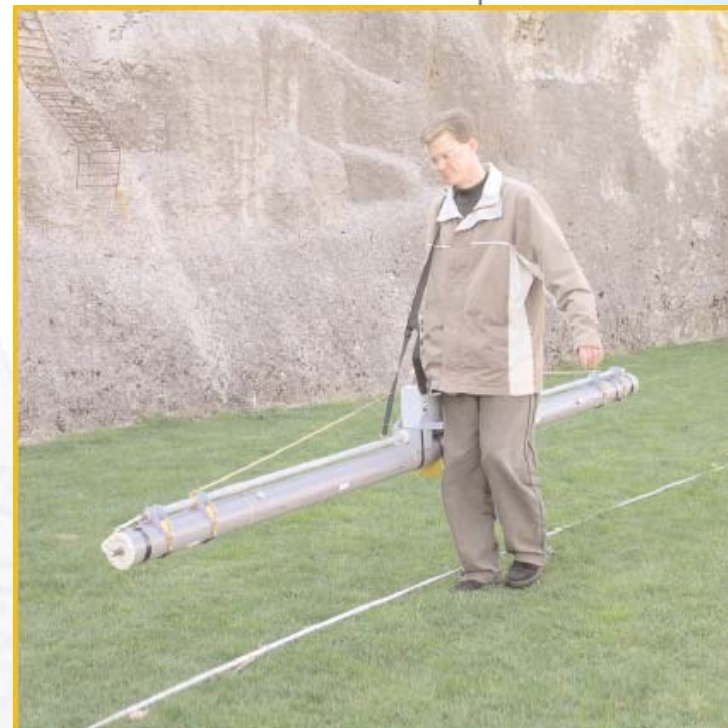
Magnetometro a corrente transiente. Il progetto dei sistemi è a cura del Corso di Laurea in Scienze dei Beni Culturali e Ambientali.
